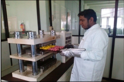
පීඩක යන්ත්‍රයක් උපයෝගී කර ගනිමින් ස්වභාවික රබර් (NR) සහ අඩු සනත්වයක් සහිත පොලිඑතිලින් (LDPE) සංයෝගවලින් සම්පීඩිත වාත්තු නිෂ්පාදනය කිරීම
