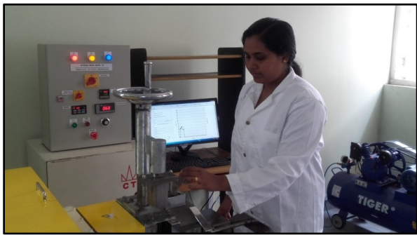
අළුතින් මිලදී ගන්නා ලද පරිගණක ගත කළ පර්යේෂණාගාර පරිමාණයේ අභ්‍යන්තර මිශ්‍රකය භාවිත කරමින් රබර් සහ රබර් ප්ලාස්ටික් සංයෝග නිපදවීම
