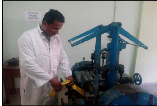
රෝල දෙකේ ඇඹරුම් යන්ත්‍රයක් උපයෝගී කර ගනිමින් අඩු ප්‍රත්‍යාස්ථතාවකින් යුත් ඉහළ සර්ෂණ ප්‍රතිරෝධයක් සහිත රබර් බෝල සංයෝගයක් නිෂ්පාදනය කිරීම
