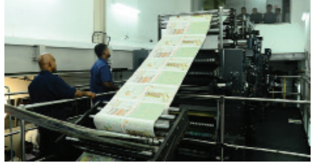
Goss Magnum அச்சீட்டு இயந்திரத்தின் பொருட்டு புதிய அச்சீட்டு தூண் பொருத்துதல்
